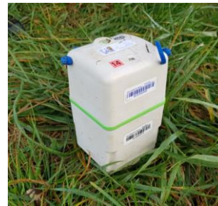
Figure 8 : Capteur sismique non permanent positionné dans le sol.
